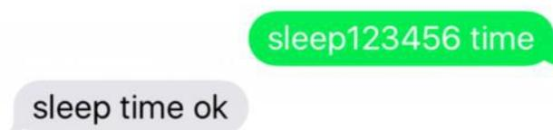
Der Tracker ist für die eingestellte Zeit im Betriebsmodus, danach geht der Tracker wieder in den Ruhemodus, die GPS Verbindung wird geschlossen. Die GSM Verbindung arbeitet mit niedrigem Verbrauch weiter. Durch einen SMS Befehl wird der Tracker wieder aufgeweckt.
